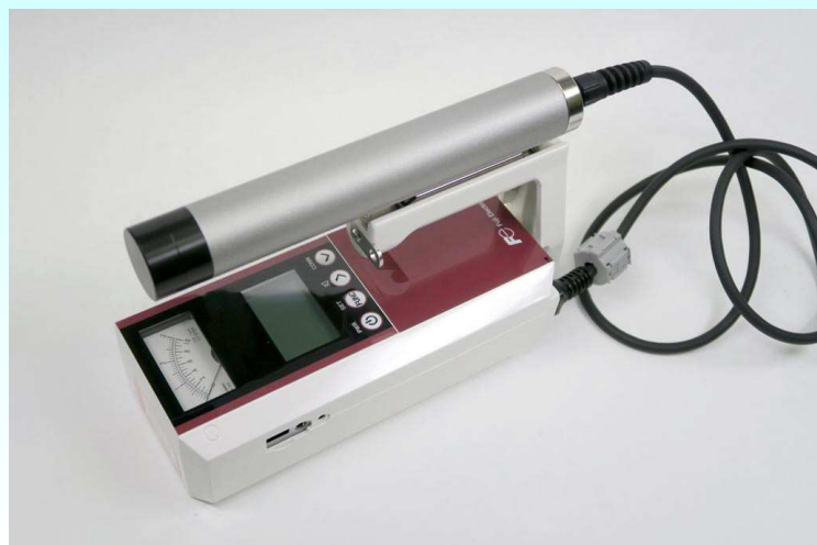
富士電機 NHC6 φ 12.7 × 12.7mm NaI シンチレーター 測定範囲 X線 8~300keV (~60 μSv/h), γ線 50~1500keV (~600 μSv/h)
