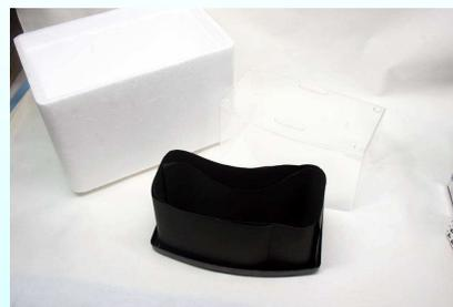
下で使用している大型コレクションケースの底板をひっくり返した皿にエタノールを溜め、黒画用紙で吸い上げて蒸発させ、ケースで覆って周囲を丁度良い大きさの発泡スチロールの箱で覆えば、林式霧箱を非常に簡易に再現可能。ただし消毒液を使うと結露するため純エタノールを使用する必要がある。
