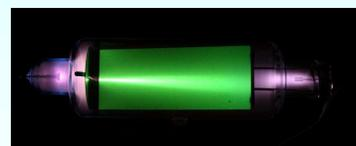
現行の教科書にも記載されているクルックス管は、製品によっては 15cmの距離で、 $70\mu\text{m}$ 線量当量率が  $200\text{mSv/h}$  にも達する高い線量率の低エネルギーX線が放出されている場合があります。知らないで近付いたりすると非常に危険です。
