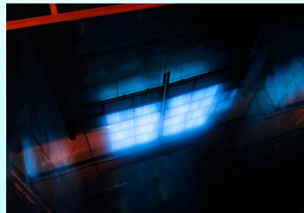
コーガイイトープ社の Co-60 ガンマ線源からのチェレンコフ光
