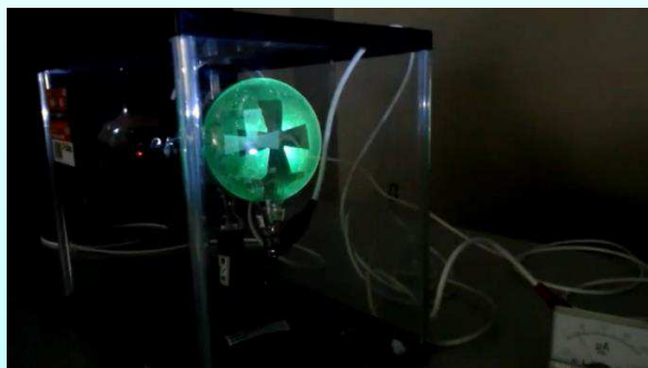
ガラスの水槽でX線を遮蔽した状態のクルックス管の実演。
