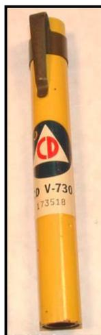
※箔検電器と同様の原理を用いた線量計として、ポケットチェンバーという携帯型の線量計が
