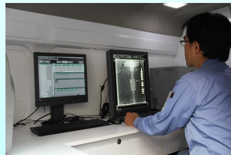
非破壊検査株式会社の車載コンピューテッド・ラジオグラフィ検査システム (FCR)
