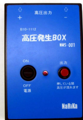
9V電池駆動の 5kV CW高圧電源
