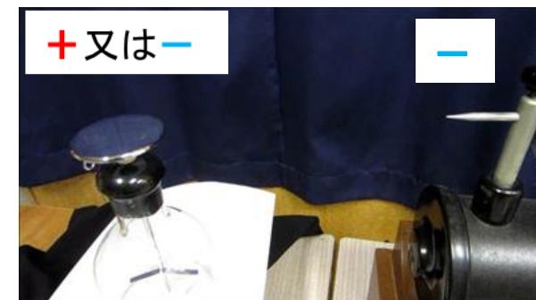
コロナ放電が起きないように尖った針電極を取り外し、支持棒電極とクルックス管を接続する
