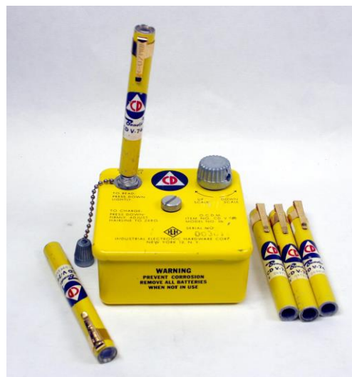
図 6 米国製ポケットチェンバー、CDV-750 ‘civil defense dosimeter’。高電圧を印加して泊を開き、被ばくした線量増加と共に箱が閉じていくのをクリップの側のレンズから光源を見ることにより、直読することが出来る。
