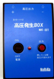
9V電池駆動の 5kV CW高圧電源
