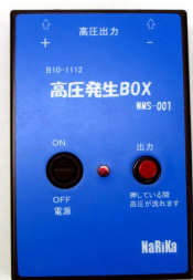
9V電池駆動の 5kV CW高圧電源
