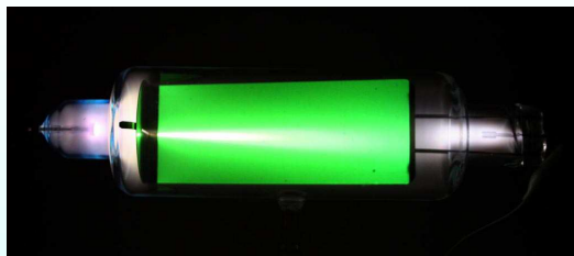
5kV で動作中のクルックス管
