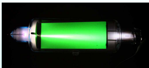
5kV で動作中のクルックス管
