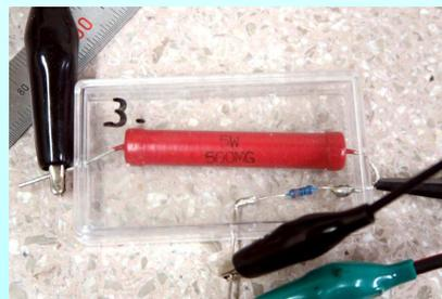
電圧測定時にはガラス抵抗体などの物理的にもサイズの大きい、100M $\Omega$ 以上の抵抗と、100k $\Omega$ 程度の抵抗を組み合わせた分配器を用いて測定するが、アースを取っていないとカソード側も高電圧をパルス的に出しているため、2chのオシロスコープでアノード側との差分を取る必要がある(フローティング測定)。
