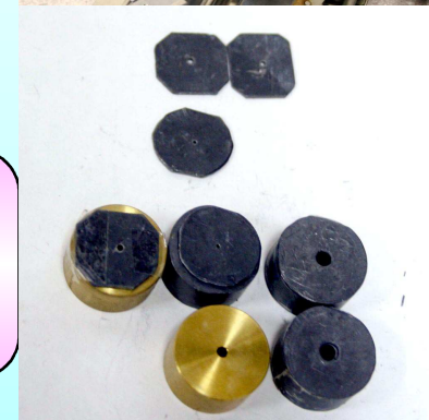
φ3同軸鉛コリメーター φ2同軸黄銅コリメーター φ1.0鉛薄板コリメーター φ0.5鉛薄板コリメーター
