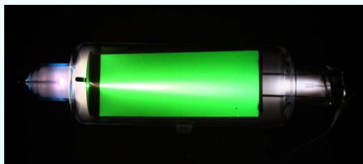
5kV で動作中のクルックス管
