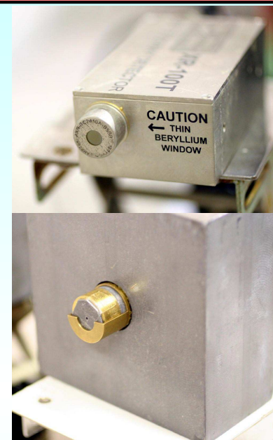
Amptek XR-100T-CZT CZT(Cd 0.9 Zn 0.1 Te)検出器 Be窓、ペルチェ冷却
