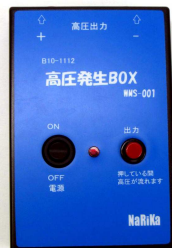
9V電池駆動の 5kV CW高圧電源
