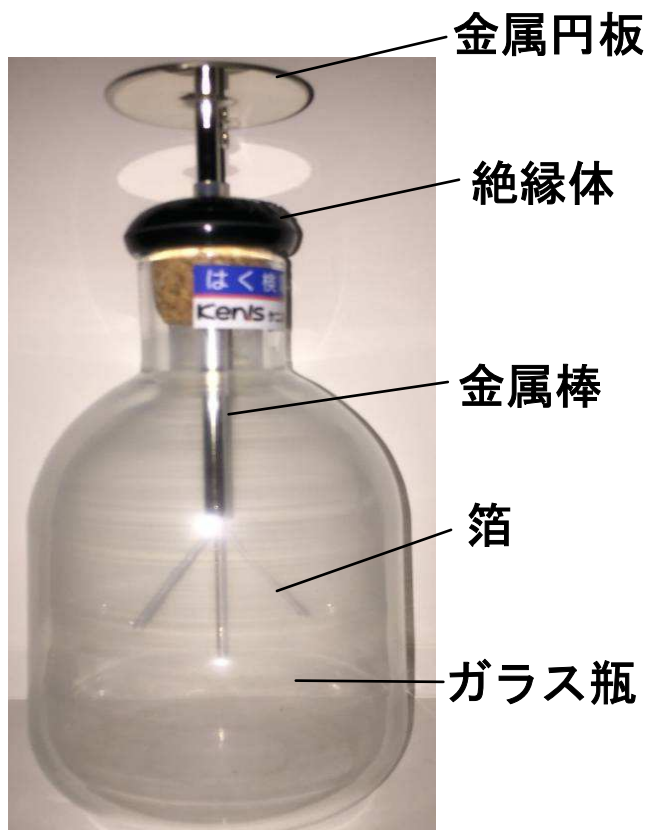
使用した箔検電器 (はく検電器EA)
