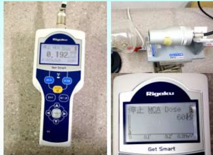
Rigaku Get Smart XU NaI シンチレーター 測定範囲 5~300keV(～10 μ Sv/h)
