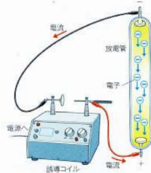
【図42】放電管内の電子の移動
