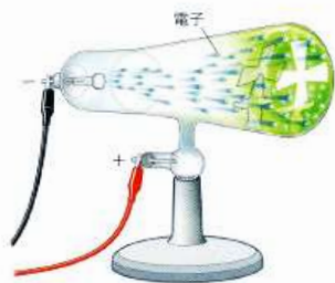
【図41】十字板入り放電管と電子のモデル 一極側から出た電子が十字板に当たり、そのうしろに影をつくる。ガラス壁に衝突した電子は、+極側に移動していく。
