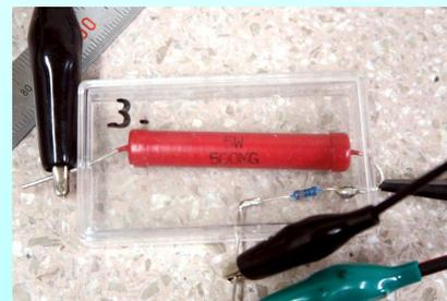
電圧測定時にはガラス抵抗体などの物理的もサイズの大きい、100M $\Omega$ 以上の抵抗と、100k $\Omega$ 程度の抵抗を組み合わせた分配器を用いて測定するが、アースを取っていないとカソード側も高電圧をパルス的に出しているため、2chのオシロスコープでアノード側との差分を取る必要がある(フローティング測定)。
