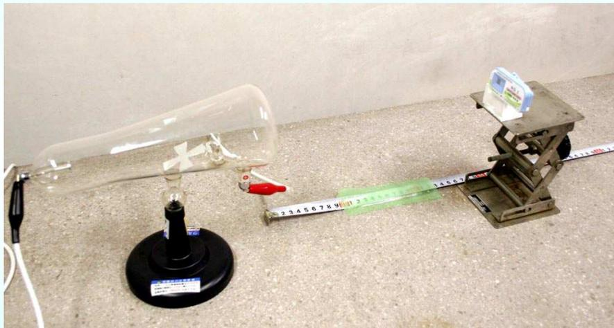
低エネルギーのX線でも測定可能な信頼できる測定手段として、蛍光ガラス線量計を用いた、千代田テクノルのガラスバッジによる環境線量測定サービスを利用した。また、日立の最新の電離箱 ICS-1323もテストした。
