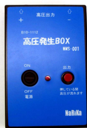
9V電池駆動の 5kV 高圧電源
