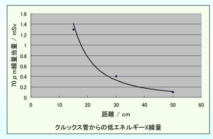
低エネルギーのX線でも測定可能な信頼できる 測定手段として、蛍光ガラス線量計を用いた、 千代田テクノルのガラスバッジによる環境線量 測定サービスを利用した。 ケニスの誘導コイルの放電針距離20mm(20kV強に相当)、十字板付きクルックス管の十字板を下げた状態で測定。
