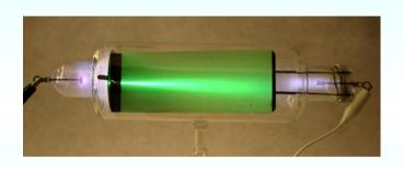
← 5kV で動作中の クルックス管 → 9V電池駆動の 5kV 高圧電源
