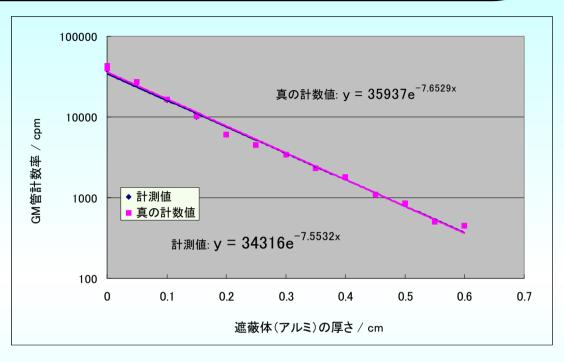
GMサーベイメーターの前にアルミ遮蔽板を置いていき、透過率を測定した。 測定結果から線減衰係数を求めると、7.65cm<sup>-1</sup> となり、放電針距離の 20mm から想定されるエネルギー20keV強でのアルミの線減衰係数と非常 に良い一致を示した。
