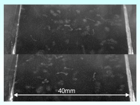
クルックス管からのX線によって弾き出された 光電子の霧箱観察結果(放電針距離20mm)。
