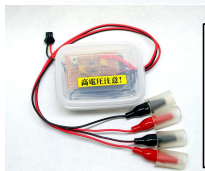
本体ユニット(上) コッククロフト型 高電圧ユニット(左)
