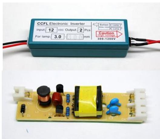
図 9. 冷陰極管用インバータ回路の例
