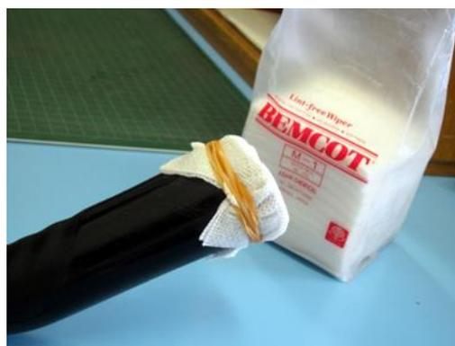
図 7. ベンコットと掃除機を用いて空気中のラドントロン娘核種を捕集している様子
