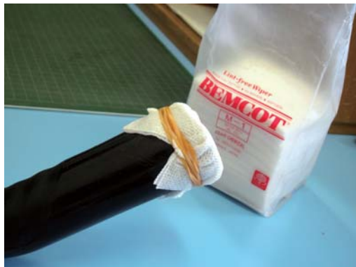
図12 掃除機とガーゼを用いた空気中のラドン娘核種の捕集の様子。目の詰まったろ紙やペーパータオルとは全く違った次元の捕集効率で、短時間での捕集が可能です。
