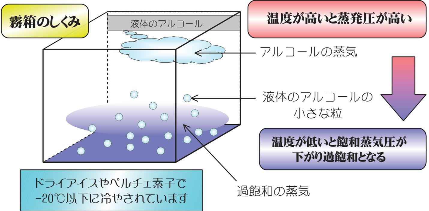
温度が低くなり飽和蒸気圧が低くなると、蒸発した気体のアルコールは液体に戻ろうとします。霧のように見える白い粒子は液体のアルコールの小さな粒です。しかし、温度が下がったのに液体の粒にならずに過飽和状態の気体も漂っています。そこに刺激を加えてやると、過飽和の蒸気は次々に液体の粒に変化していきます。
