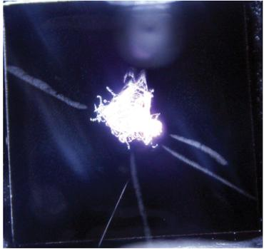
過飽和の蒸気は冷やされている容器の底に薄く広がっているだけなので、底に平行に走った放射線しか見ることができません。また液体の粒はすぐ蒸発してしまって、数秒で見えなくなってしまいます。
