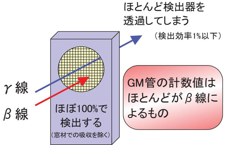
実効線量率を表示する検出器 → Cs-137のγ線の検出効率から逆算して計数値から実効線量を計算している
