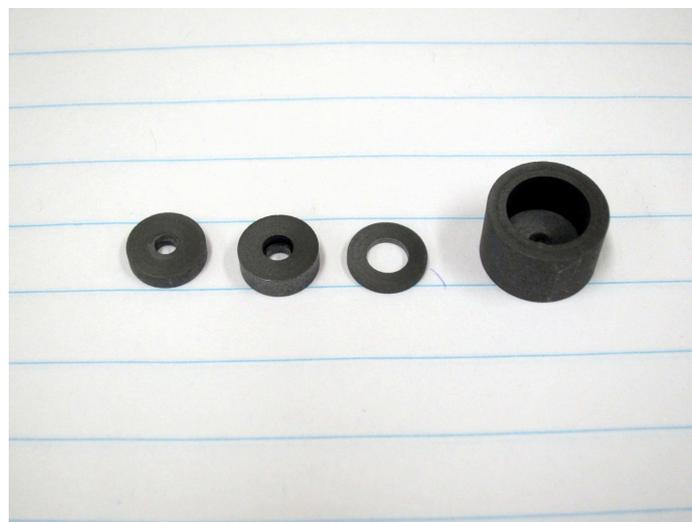
加工の容易な黒鉛で作成した治具。測定の可否に関する検証を行なった後、TiやNi等の高融点金属で耐久性のある治具を作成する予定。
