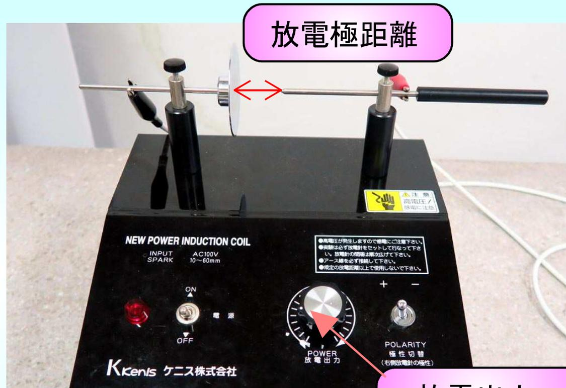
空気中での絶縁破壊電圧が 1kV で 1mm 程度であることから、放電極の距離を変えることで印加する最大電圧を規定できる。放電電圧以下では、放電出力を変えることで連続的に電圧をコントロール可能。放電電圧以上に出力を上げると無駄に放電が激しくなるので、目的の電圧を出力するためには丁度放電が起こり出す出力程度にコントロールする必要がある。
